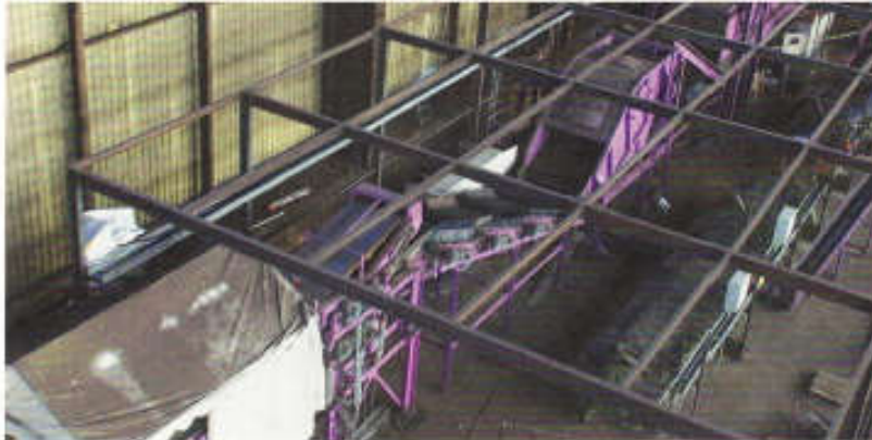
In der S.A.A.L.T.-Anlage werden die kleinen Aluminiumstücke mit Lasertechnik sortiert.
